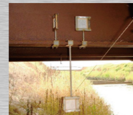
飛来塩分量測定(ガーゼ試験法)
