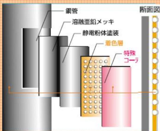
さらに反射層を設けることで、弱い光にも強く反射する(光る) = 再帰反射率の高いピカポールになります。
