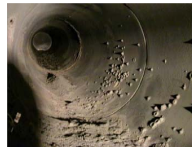
酸露点環境試験:NTAC-800Z+NTAC-1500+NTAC-G1-92
