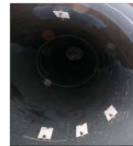
酸露点環境試験:NTAC-800Z+NTAC-1500+NTAC-G1-92
