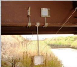
飛来塩分量測定(ガーゼ試験法)
