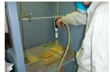
評価サンプル作製の様子 (粉体エポキシ樹脂の静電粉体塗装)
