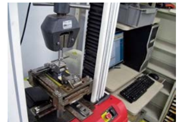
ポリオレフィン被覆の 接着力試験の様子 (万能材料試験機、インストロン社製)
